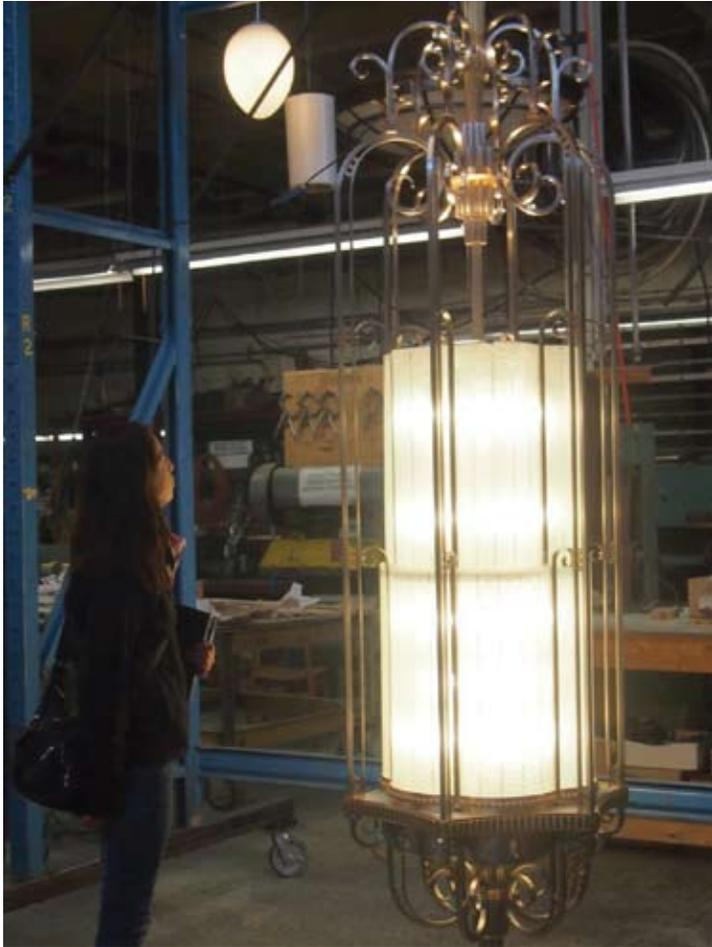
Image 68. Chandelier réhabilité, équipé de nouveau câblage et de nouvelles ampoules à DEL écoénergétiques. Édifice Sir-John-A.-Macdonald, Ottawa (Ontario). Source : MTBA Associates Inc.
